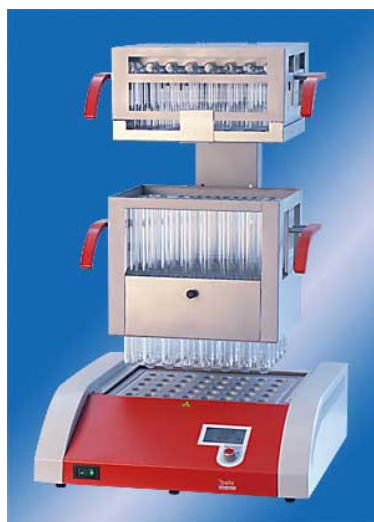
Slika 22. Blok za razaranje biljne tvari s pripadajućim kivetama i odparivačem
