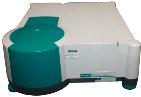
Slika 24. Spektrofotometar i princip spektrofotometrije
